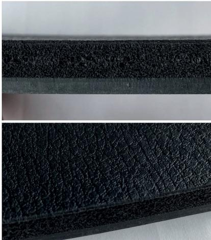
**Bild 5.** TPE-Schaummuster mit PP-Träger, gefertigt im 2K-Schaumspritzgießen: Das Verfahren ermöglicht die Herstellung von weichen ansprechenden Sichtbauteilen für das Automobilinterieur. © GK Concept
