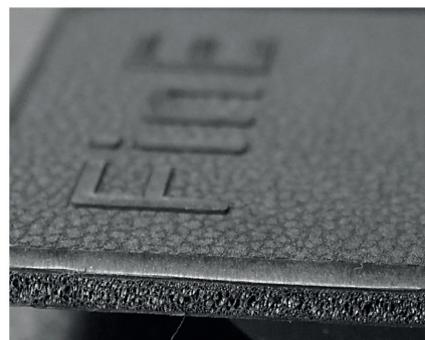
**Bild 4.** TPE-Schaummuster, gefertigt in einem 1K-Prozess: Nach Anpassung des Materials und des Verfahrens lassen sich weiche TPE-Teile mit homogener Schaumstruktur fertigen. © GK Concept
